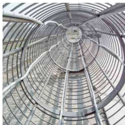
Kolumna geotermalna przed montażem
